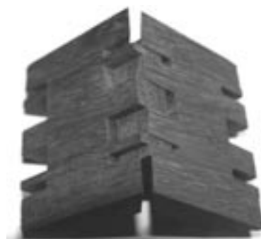
接合部の模型。多少の力を加えた程度ではズレない見事な精度
