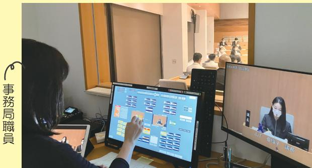
▲発言者をタッチパネル上で選択操作すると、カメラ・マイク・テロップが連動して機能する仕組みです。
