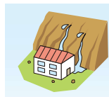
斜面から水がわき出る。
