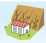
斜面にひび割れができる。
