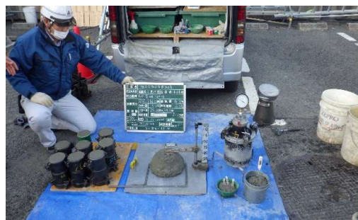
③コンクリート受入試験
