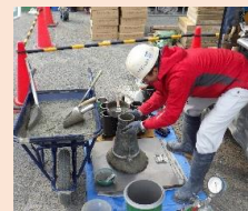
■ スランプコーン引抜きの様子
