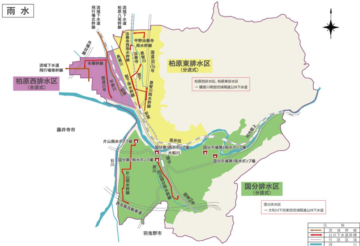
図 2-2 柏原市公共下水道事業雨水処理施設位置図
