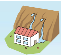
斜面から水がわき出る。
