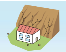
斜面にひび割れができる。
